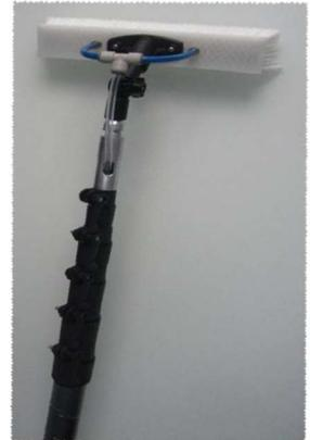
*Perche en carbone entièrement télescopique et déboîtable, connexion au System H2o OUTDOOR M150 et/ou M300, permet de nettoyer toutes surfaces lisses extérieures de 0 à 15 mètres de hauteur*
